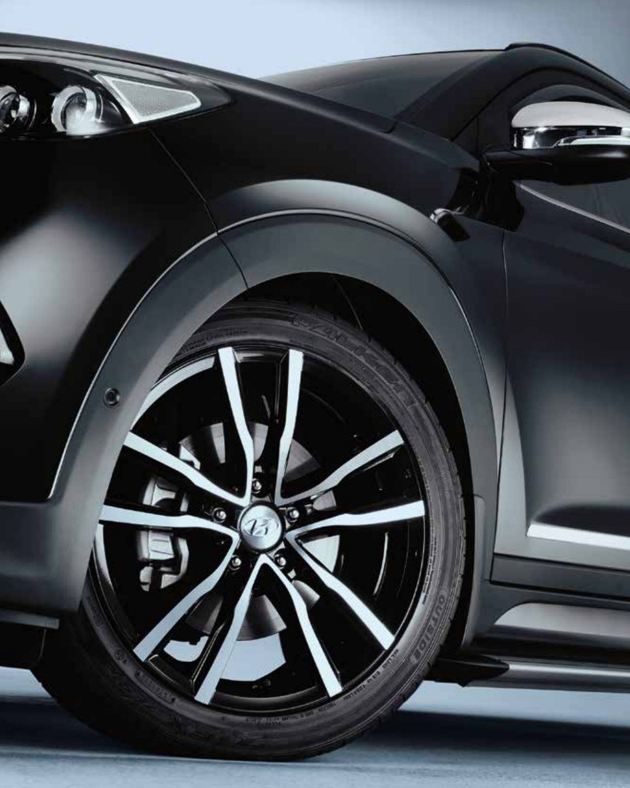
1. Zliatinový disk 16". 16" zliatinový disk s piatimi dvojitými lúčmi, 6,5J x 16, vhodný pre pneumatiky 215/70 R16. Nie je vhodný pre vozidlá s elektronickou parkovacou brzdou. Stredová puklička a matice nie sú súčasťou. 52910D7110PAC
