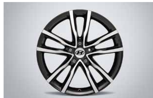
5. Zliatinový disk 18" Ulsan. 18" zliatinový disk s piatimi dvojitými lúčmi, 7,5J x 18, vhodný pre pneumatiky 225/55 R18. Stredová puklička je súčasťou, matice nie sú súčasťou. D7400ADE02
